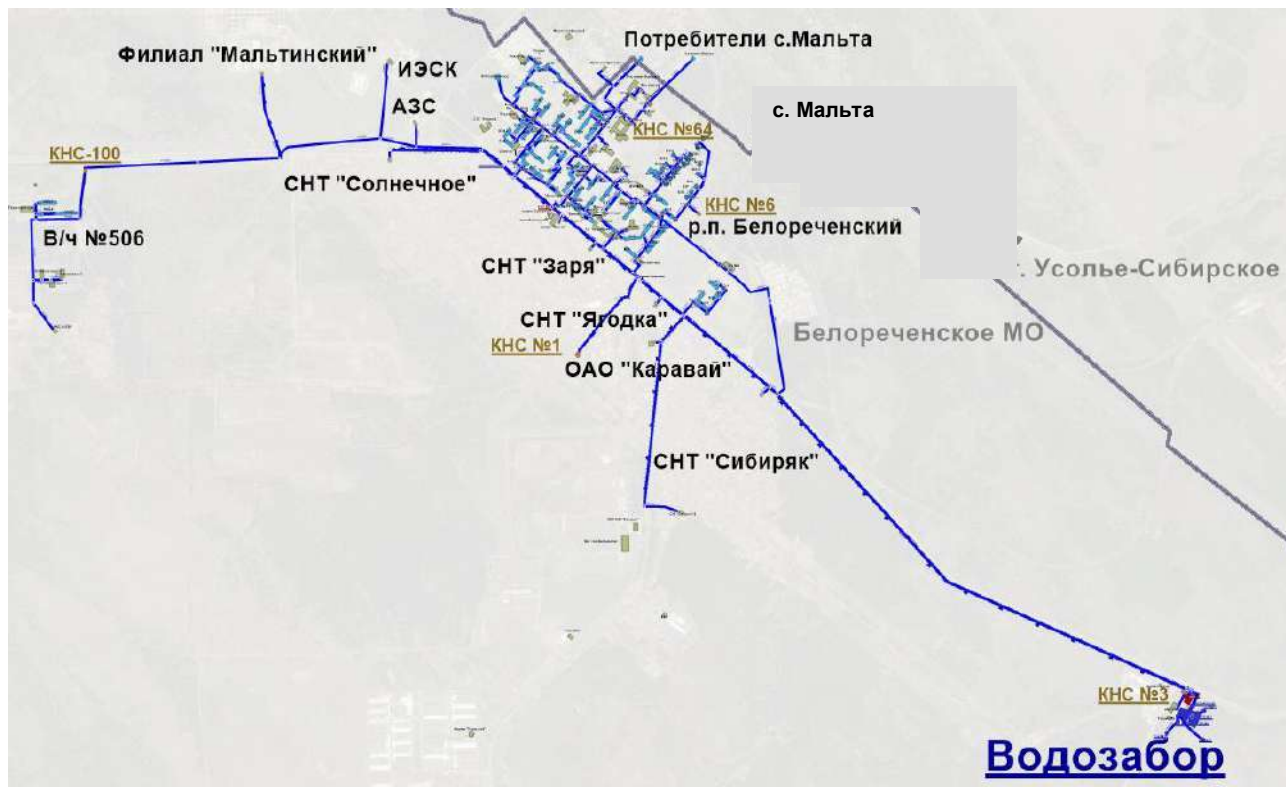
Рис. 1.1. Общая принципиальная схема централизованного водоснабжения р.п. Белореченский
