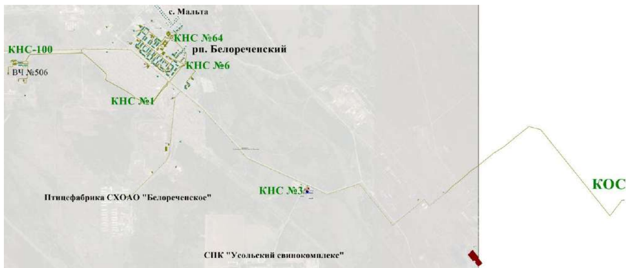
Рис. 9.1. Общая принципиальная схема централизованного водоотведения р.п. Белореченский
