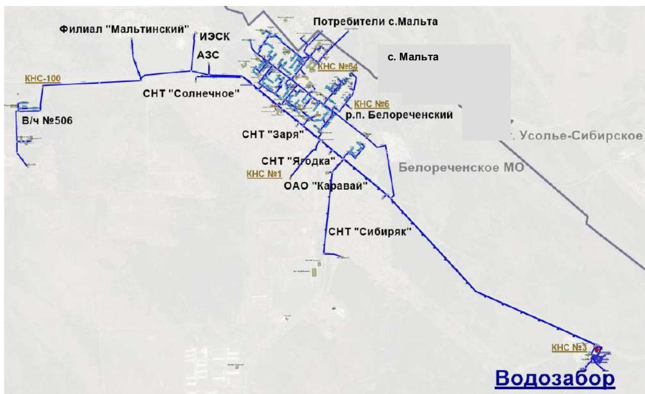
**Рис. 1.1. Общая принципиальная схема централизованного водоснабжения р.п. Белореченский**
