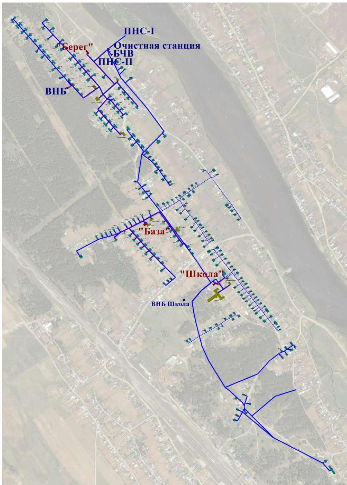
**Рис. 1.1.** Общая принципиальная схема централизованного водоснабжения с. Мальта
