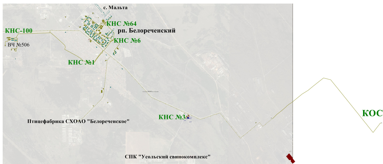
Рис. 9.1. Общая принципиальная схема централизованного водоотведения р.п. Белореченский
